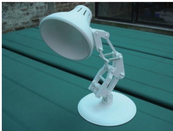
圖 2-4 3D 列印 SLA 技術成型的燈
