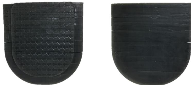
圖 54：EPX 81 樹酯所製作的入子測試射出\_第 1 模龜裂
