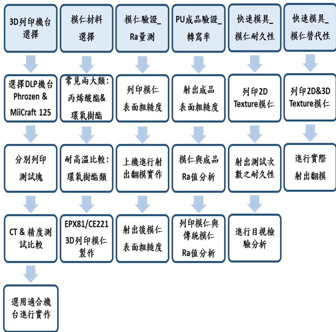
圖 30：實驗規劃與驗證流程
