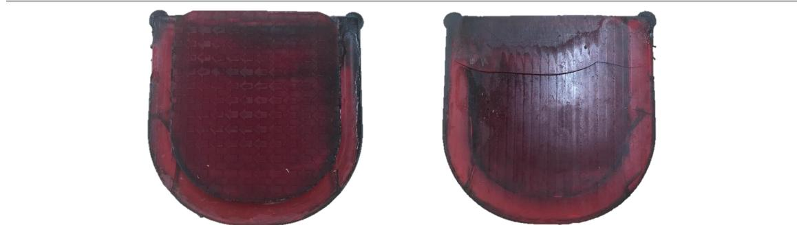
圖 55：CE 221 樹酯所製作的入子測試射出\_第 16 模龜裂
