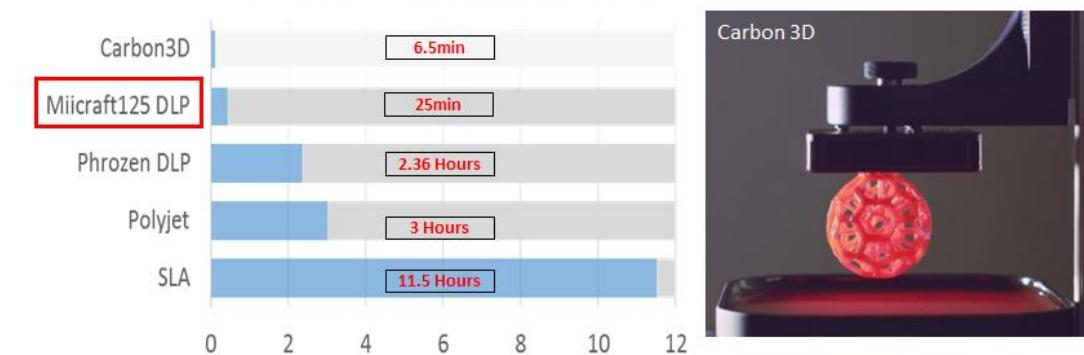
圖 49：Carbon EPX 81 樹脂\_光固化列印成品之速度比較
